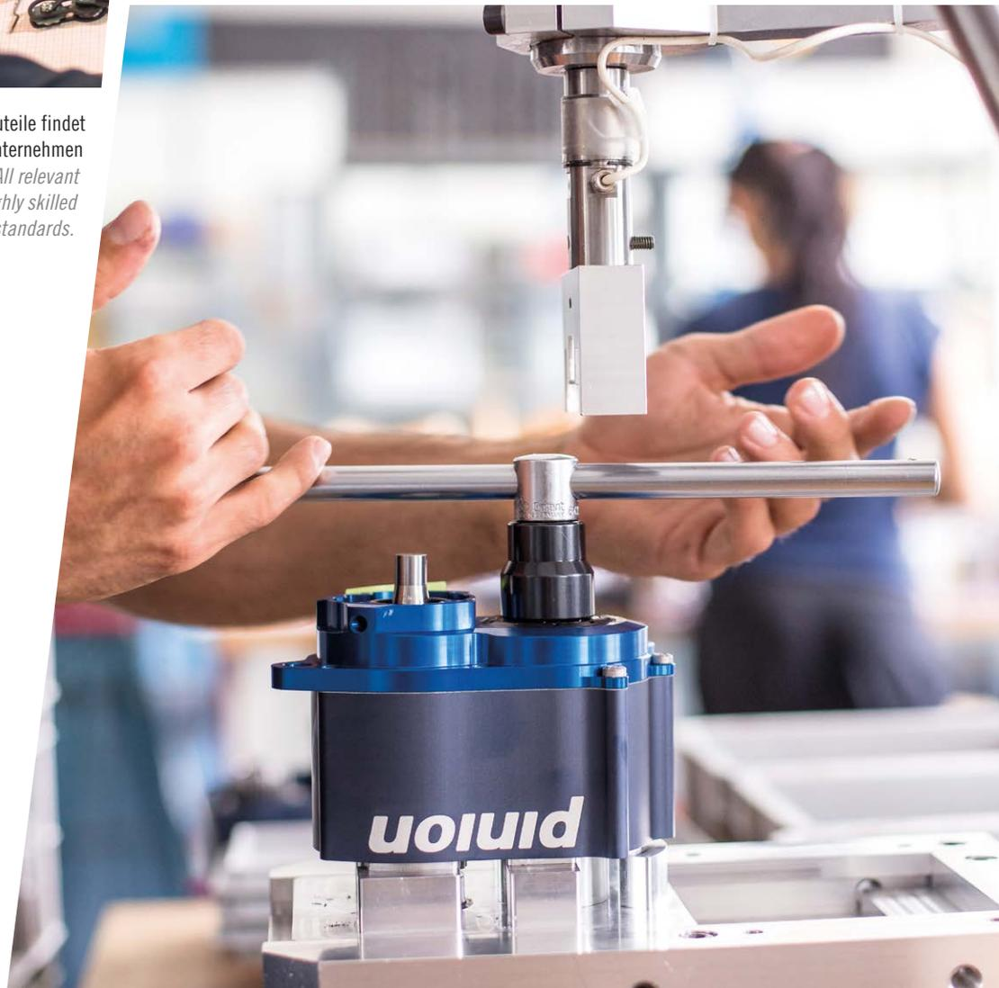
Die Getriebe-Montage und die anschließenden Serientests werden bei Pinion von erfahrenen Technikern durchgeführt. // *The gearbox assembly and the subsequent series tests are performed by experienced Pinion technicians.*
